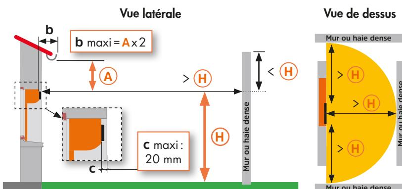
(A) = hauteur du dessus du panneau PV - (H) = hauteur à considérer par rapport au sol et non au plancher
