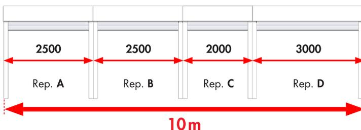
**Largeur LA :** la largeur LA doit être prise à l'entraxe des coulisses juxtaposées
