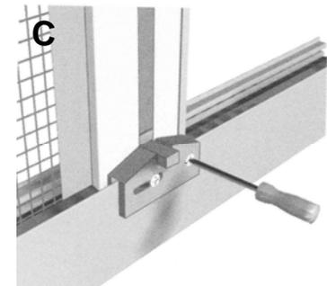
Desserrer légèrement les verrous haut et bas, enclencher le stopper dans le verrou et régler la position des verrous pour que la lame finale soit d'équerre et la toile bien tendue. Verrouiller la position des verrous en serrant les deux vis.
