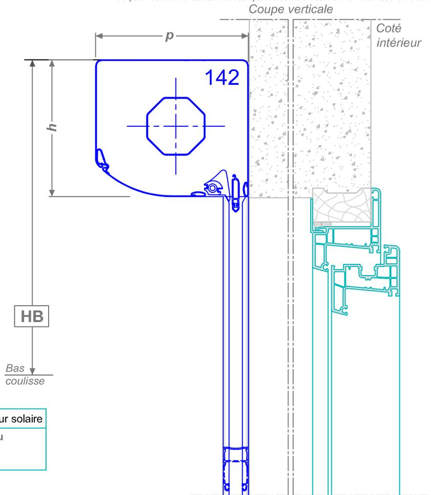
En manoeuvre SO, règles d'implantation du capteur solaire
