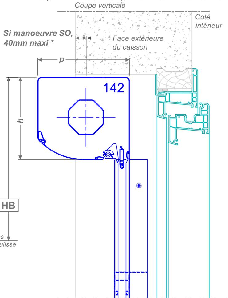
En manoeuvre SO, règles d'implantation du capteur solaire
