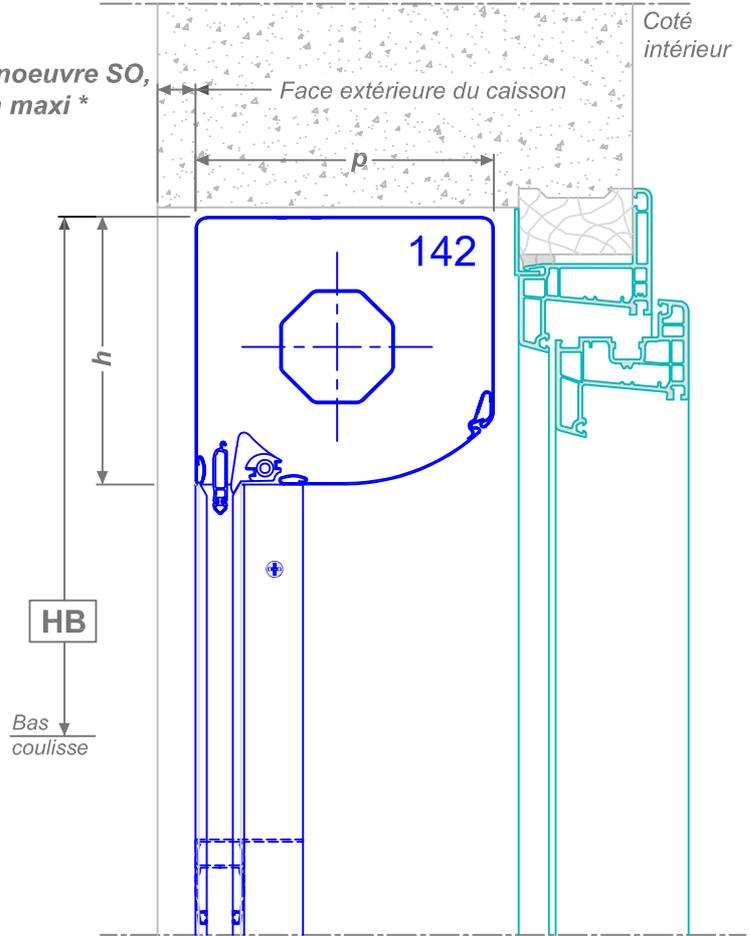
En manoeuvre SO, règles d'implantation du capteur solaire
